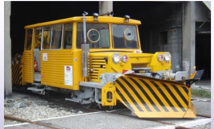
Photo : DU 65 chasse-neige, équipée de soc à lame double
