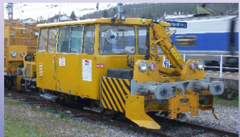
Photo : B.CIRY DU 65 "Maya" sans les socs chasse-neige avec cabine à faces lisses.
