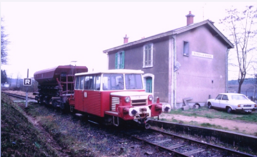
Photo : F.DANO DU 65 tractant un wagon trémie de ballast à bogies.
