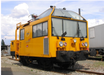
Photo: Engin d'observation caténaire, sur châssis de DU 65.
