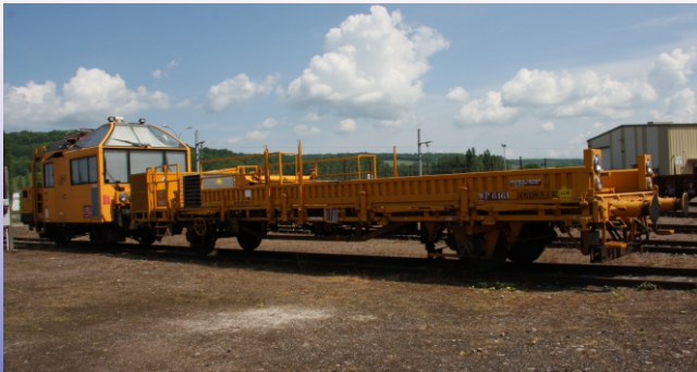
Photo: B.CIRY Engin d'observation caténaire avec son wagon d'accompagnement pour LGV.
