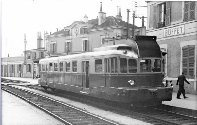
Le ZZ G 204 PLM, correspondant au modèle de série, en gare de Laroche-Migennes, avec les portes d'accès voyageurs côté moteur de type accordéon à quatre battants. (Collection REE Modèles)
