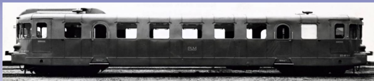
L'autorail ZZ 66 G1 du PLM, quatrième prototype construit, et premier de cette Compagnie. La porte d'accès au compartiment moteur est une portière ouvrant vers l'extérieur. (Collection REE Modèles)
