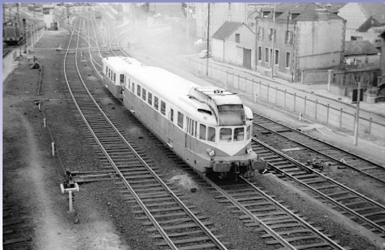
Un autre VH du dépôt de Montluçon quitte la gare, le 3 avril 1967, tractant une remorque Verney à deux essieux. Il ne comporte qu'une petite fenêtre entre la porte d'accès voyageurs et la porte de service de l'extrémité 2 (Photo Bernard NEVEU - Collection REE Modèles).
