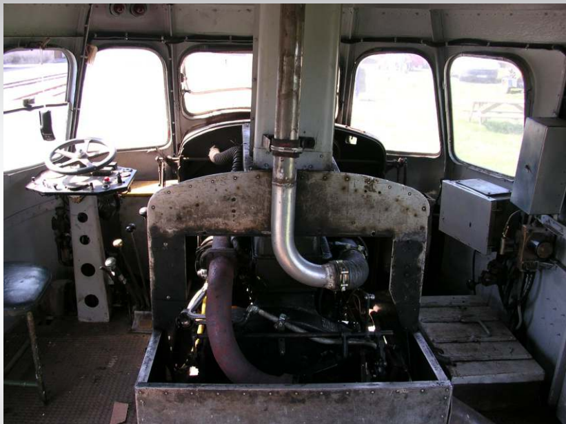
Photo : Cabine de conduite et moteur d'un A80D - Coll. D. Buraud
