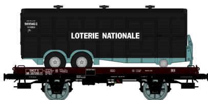
Réf. WB-241 - Wagon UFR Mono-Porteur Ep.III W-009-D-08 Wagon freiné, boîtes d'essieux coussinets, roues à rayons N° 597 638
