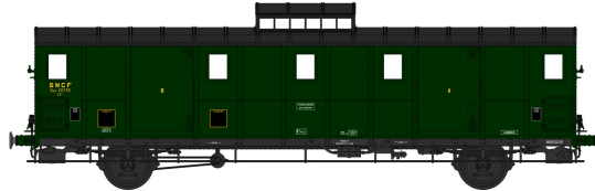
Réf. VB-010 - FOURGON OCEM 30 Ep.III V-001-D-02 Fourgon Toit riveté Noir, Vigie, boîtes d'essieux à coussinets, N°25735 « LIMOGES » Ex -PO Grille
