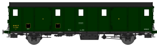
Réf. VB-011 - FOURGON OCEM 30 Ep.III AVEC FEUX FONCTIONNELS - Prise Décodeur V-001-B-04 Fourgon Toit lisse noir, 2 petits feux 1 Droit, boîtes d'essieux à coussinets, N°39907 « BATIGNOLLES » Ex-ETAT Barre
