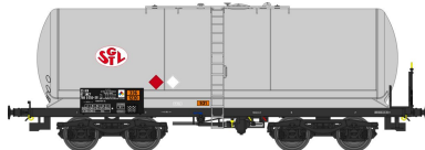
Réf. WB-200 - Wagon Citerne ANF Ep.IV-V "SGTL" W018-G-01 - Citerne courte, bogie Y 25S boîtes SKF, N° 33 87 788 0 356-3
